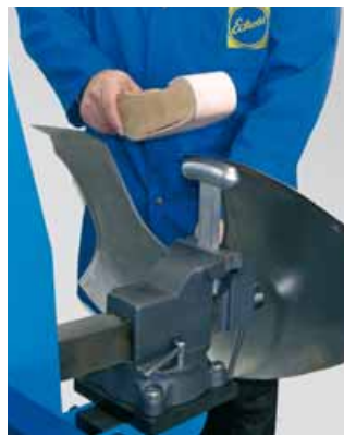
Schraubstock, schwenk- und höhenverstellbar und geeignet zum einspannen von Handformer-Gerätekopf oder verschiedenem Zubehör (z.B. T-Ambosse).
