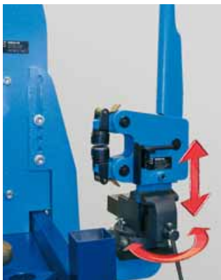
Schraubstock, schwenk- und höhenverstellbar und geeignet zum einspannen von Handformer-Gerätekopf oder verschiedenem Zubehör (z.B. T-Ambosse).
